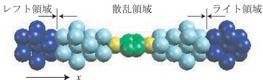
図 8: ベンゼンジチオール分子架橋系の結晶構造。濃色の原子がレフト領域、ライト領域として扱われる Au 原子を表す。
