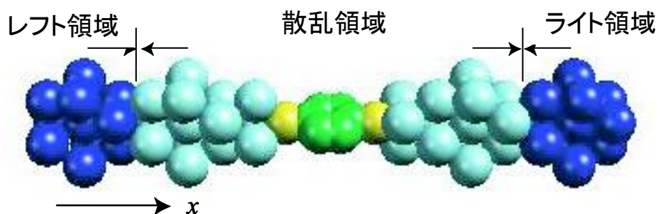
図 4.1 ベンゼンジチオール分子架橋系の結晶構造。濃色の原子がレフト領域、ライト領域として扱われる Au 原子を表す
